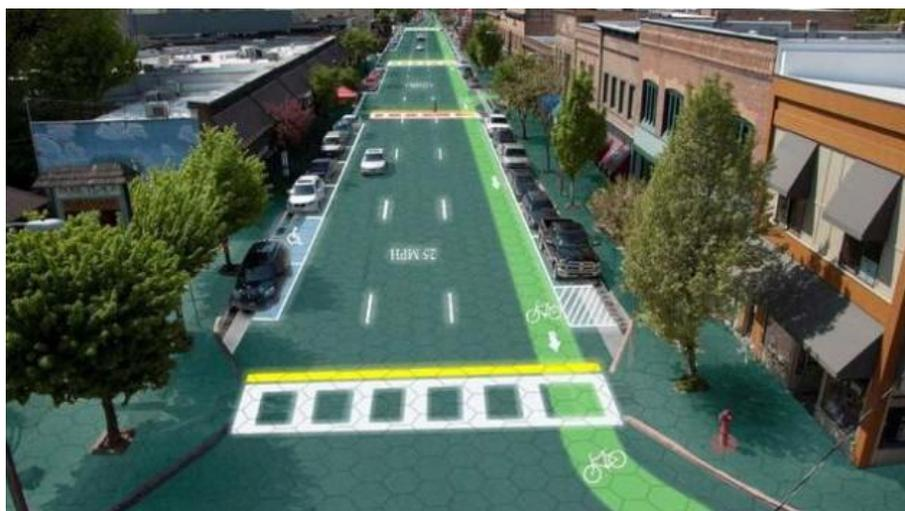
作为水泥和沥青的高科技替代品，六边形的太阳能板将会吸收太阳能并将一部分转化成电能传入电网。更有趣的是，太阳能板还将配备 LED 灯，可以用来显示车道标志和限速信息。
